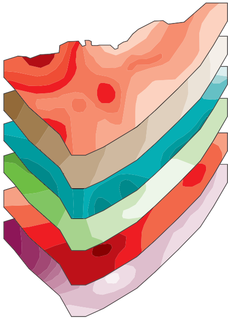
Figura 2 | Representación esquemática de diferentes niveles de datos que describen las características físicas de la Bahía de Florida observadas en la Figura 1. Cada mapa representa una variable diferente, como salinidad, concentración de nitrógeno, profundidad de sedimentos, materia orgánica de sedimentos, etc. Estas tablas de datos o niveles diferentes pueden superponerse para definir áreas dentro de la bahía que tengan un conjunto específico de características.
